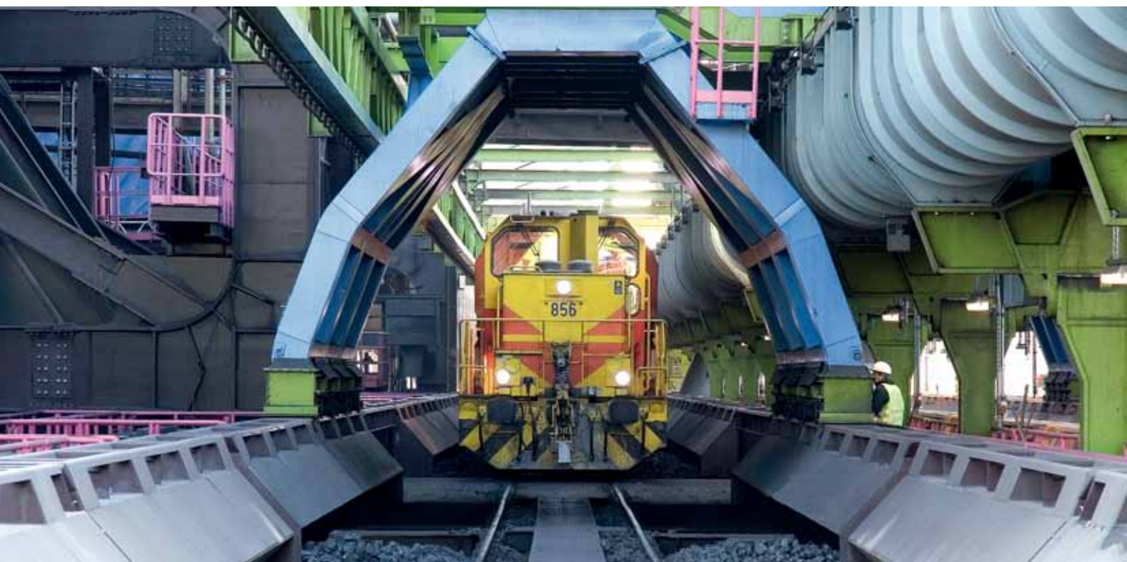
Mobiles Stauberfassungssystem auf der Hochbahnbunkeranlage im Hochofenbetrieb bei der ThyssenKrupp Steel Europe AG in Duisburg-Hamborn
